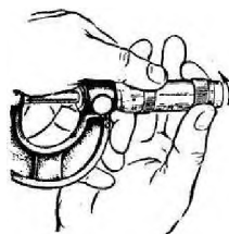
Рис.5 Закрепление барабана микрометра корпусом трещотки
